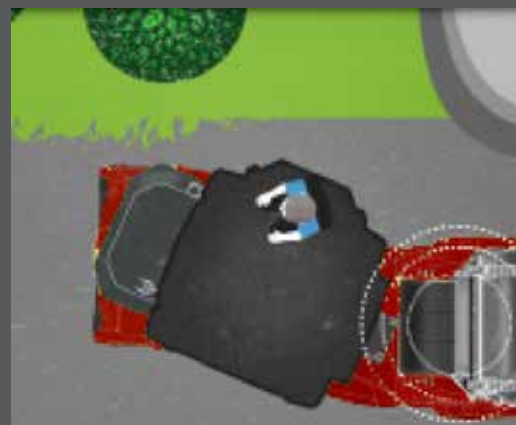
PESO SITUADO CASI EN EL CENTRO DE LA CALZADA Al compactar bordes frágiles en calzadas, es posible mantener el peso de la máquina casi en el centro de la calzada.
